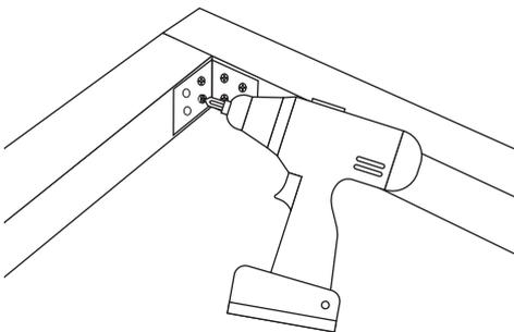
3. Setzen Sie zwei Latten mit 100 Zentimetern Länge und zwei Latten mit 140 Zentimetern Länge unter Verwendung der Eckverbinder zu einem Rechteck zusammen. Verschrauben Sie alles mit Holzschrauben.
